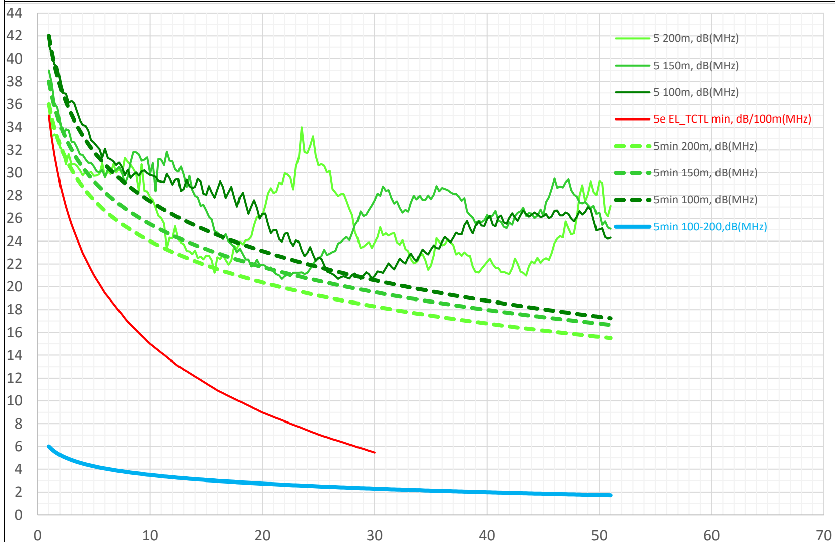
Рис. 7-3. Защищенность от затухания асимметрии на дальнем – EL_TCTL , дБ(МГц); цвет – пара; данные пары для 100, 150, 200 м
