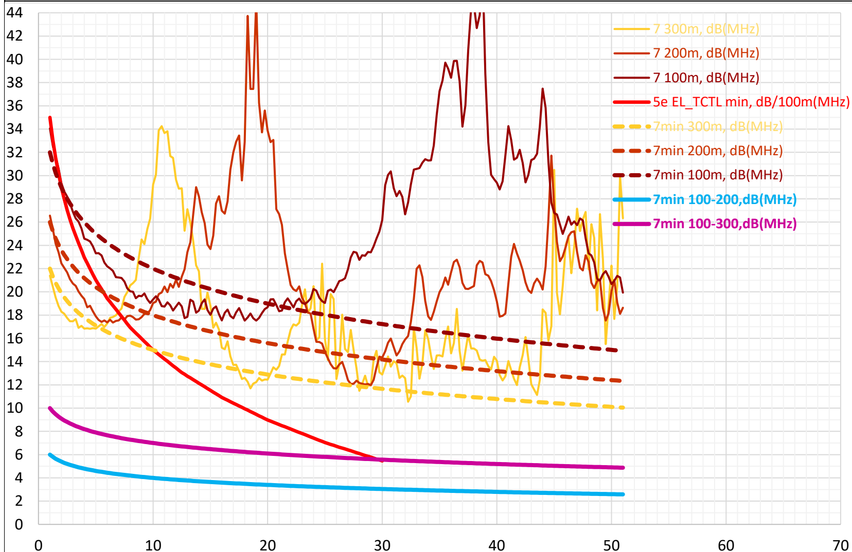
Рис. 9-4. Защищенность от затухания асимметрии на дальнем – EL_TCTL , дБ(МГц); цвет – пара; данные пары для 100, 200, 300 м
