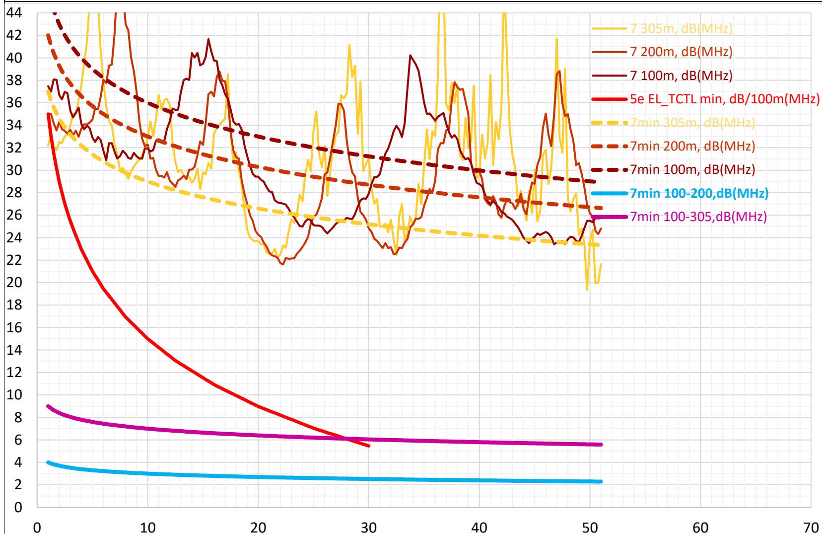
Рис. 8-4. Защищенность от затухания асимметрии на дальнем – EL_TCTL , дБ(МГц); цвет – пара; данные пары для 100, 200, 305 м
