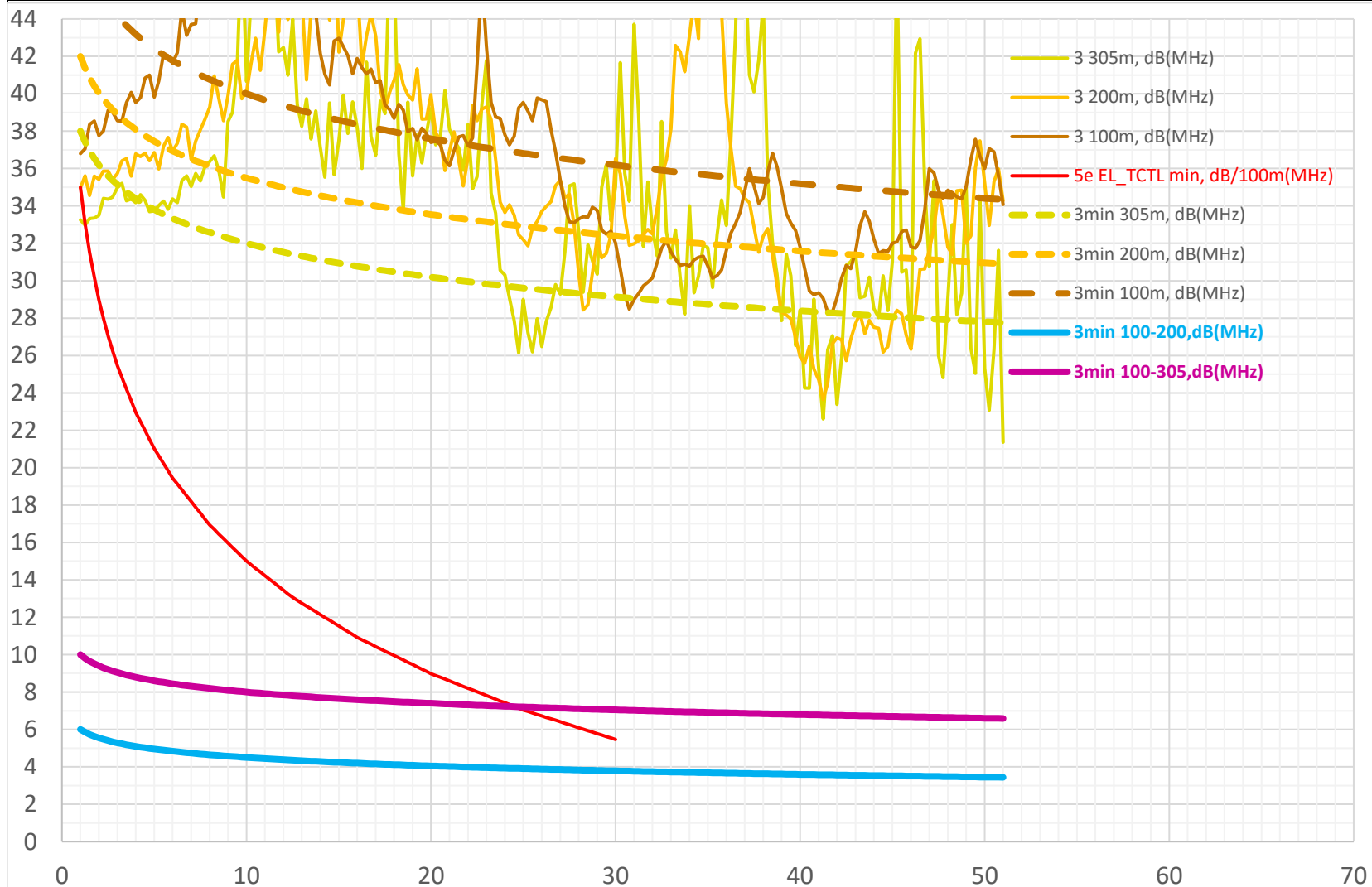
Рис. 8-2. Защищенность от затухания асимметрии на дальнем – EL_TCTL , дБ(МГц); цвет – пара; данные пары для 100, 200, 305 м
